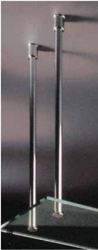
Baldakijn Omschrijving : Buis Ø20 mm. Lengte (mm) : 1000 en inkortbaar. Min. tabletdikte (mm) : 9. Diameter tabletboring (mm) : 14.
