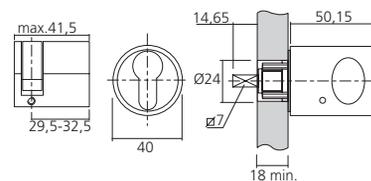
Tournant, Ø40 mm pour panneaux d'épaisseur de 18 à 26 mm.
