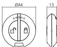
Actionne la serrure électronique, ouverture / fermeture.
