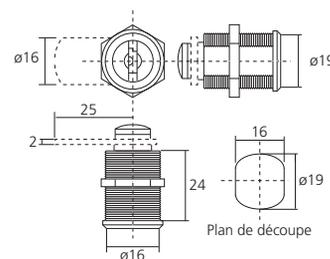
Avec filet extérieur pour tout matériau allant jusqu'à 19 mm d'épaisseur.
