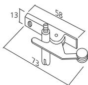
Permet le blocage d'une double porte. Matériau : acier/nylon
