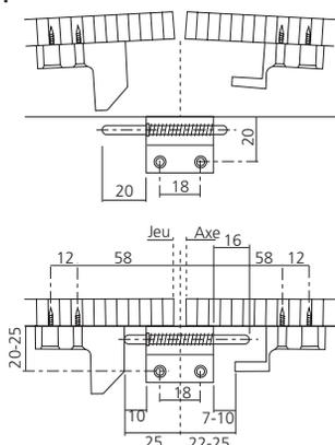
Permet de bloquer une double porte en position fermée sans serrure 3 points. Réversible. Livré en set complet pour une double porte.
