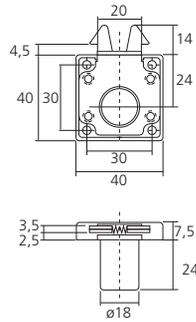
Avec pêne à crochets. Cylindre Ø18 x 24 mm.
