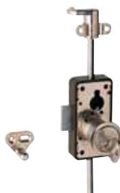
A double sens, en applique, avec tringles tournantes. Boîtier plastique, cylindre en laiton nickelé. Livrée avec une rosace en laiton nickelé et 2 clés plates.
